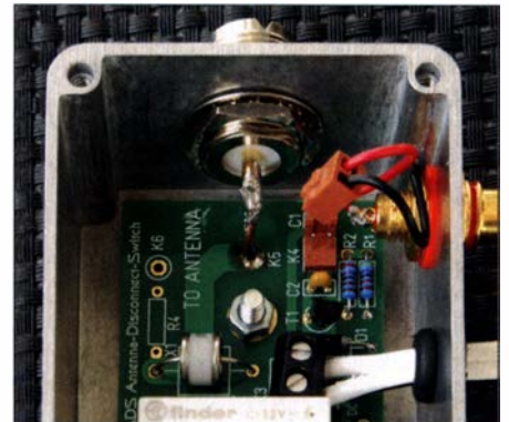
Bild 8: Verbindung von Antennen- und Fernschaltbuchse sowie der Spannungsversorgung mit der Platine
