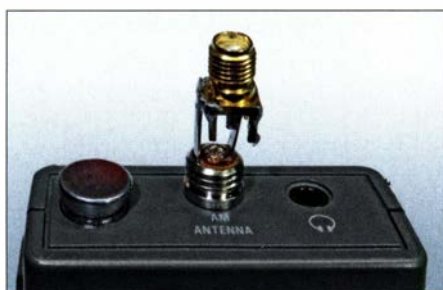
Bild 2: In Ermangelung des am Antennenanschluss erforderlichen Steckers habe ich einen 3,5-mm-Klinkenstecker (Mono) mit einer SMA-Buchse zu einem Adapter verlötet.
