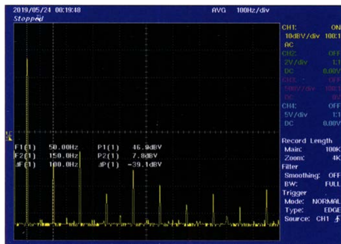
Bild 12: Spektrum des sinusförmigen Ausgangssignals des Wechselrichters; die Messung der dritten Harmonischen ergab eine Unterdrückung von etwa 39 dB.
