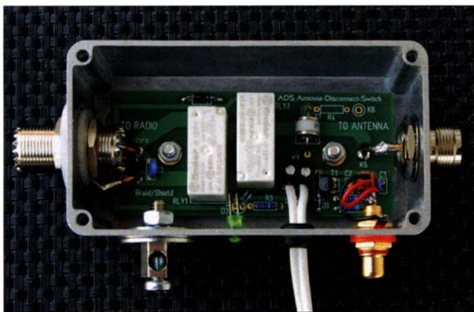
Bild 1: Antennentrennschalter im geöffneten Aluminium-Druckgussgehäuse; links befindet sich die Koaxialbuchse für den Anschluss der Funkstation, rechts die Buchse für die Antenne.
