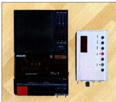
Zu HSCW-Zeiten waren modifizierte Tonbandgeräte oder Kassettenrekorder ein „Muss“, um die hohen Tastgeschwindigkeiten auf ein lesbares Niveau zu bringen. Der Philips D6350 verfügte bereits von vornherein über eine Geschwindigkeitsregelung. Diese musste man nur noch erweitern und das Gerät einstrahlfest machen. Der digitale Rekorder DTR von DF7KF ermöglichte sogar das Decodieren von jenseits der 2000 BpM. Foto: DF2ZC
