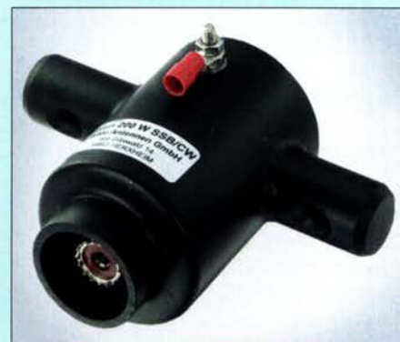
Bild 8: 1:1-Balun für 200 W Sendeleistung mit seitlichen Armen zur Zugentlastung; der zweite Dipolanschluss ist an der Rückseite.
