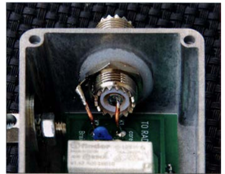
Bild 7: Verdrahtung der zur Funkstation führenden SO239-Anschlussbuchse
