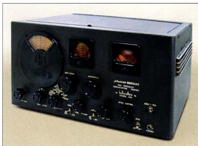
Bild 3: Hallicrafters baute den Empfänger SX-24 Skyrider Defiant für anspruchsvolle Radiohörer und KW-Amateure. Foto: Wikipedia CC-BY-SA-2.0/Sam Stokes
