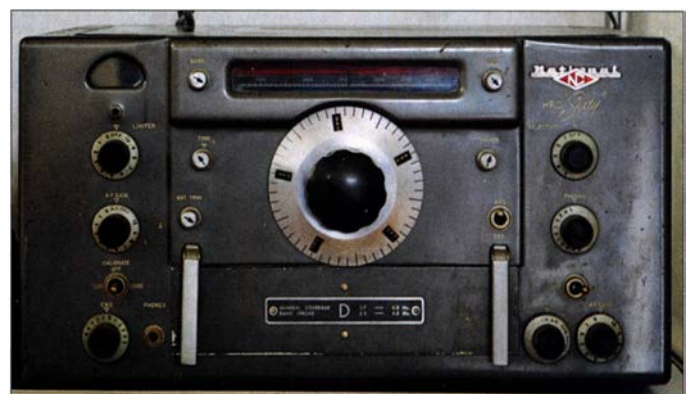
Bild 2: Der National HRO-60 Communications Receiver wurde von 1952 bis 1964 gebaut und setzte Maßstäbe in der Empfängertechnik.
