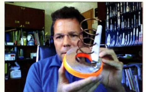
DO8PAT erklärte seine Lösung für Funkbetrieb über QO-100, darunter eine selbstgebaute Helix-Antenne.
