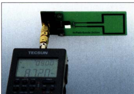
Bild 8: Die selbst hergestellte induktive Sonde lässt sich über eine kleine Adapterplatine an die Antennenbuchse stecken. Fotos: DK9EV
